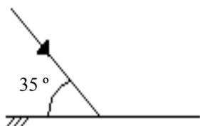
Represente, na figura, a reta normal, o raio refletido e indique os ângulos de incidência e de reflexão com seus respectivos valores.
